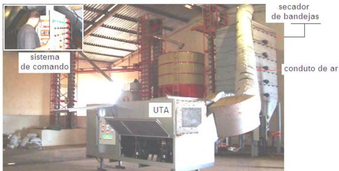
Figura 3. Vista do sistema de secagem de café, em operação em uma unidade de secagem (Catalão – GO), com destaque para o sistema automático de comando operacional.
